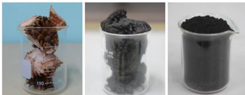
(ก) เปลือกทุเรียนตากแห้ง (ข) ถ่านเปลือกทุเรียน (ค) ถ่านเปลือกทุเรียนบด
