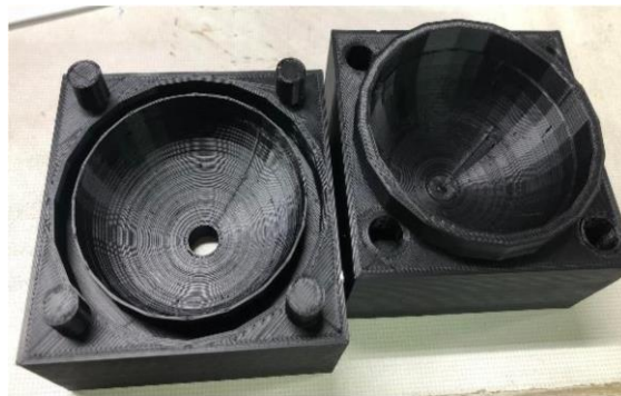
ภาพที่ 2 แม่พิมพ์บอลยาง ABS filament จากเครื่องพิมพ์สามมิติยี่ห้อ da Vinci รุ่น 1.0 Pro
