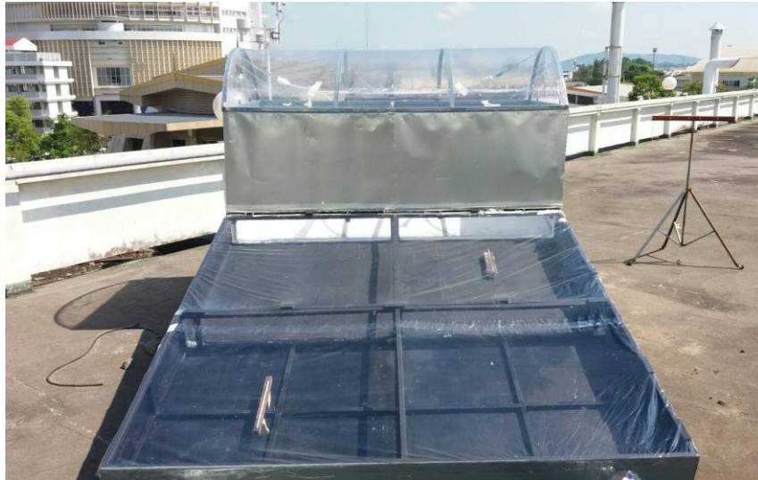
ภาพที่ 4 ระบบอบแห้งสำหรับอบแห้งชิ้นสัมแชกที่อาศัยพลังงานแสงอาทิตย์
