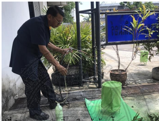
รูปที่ 3 แสดงการพ่นเพื่อเคลือบผ้าด้วยน้ำยางคอมพาวด์
