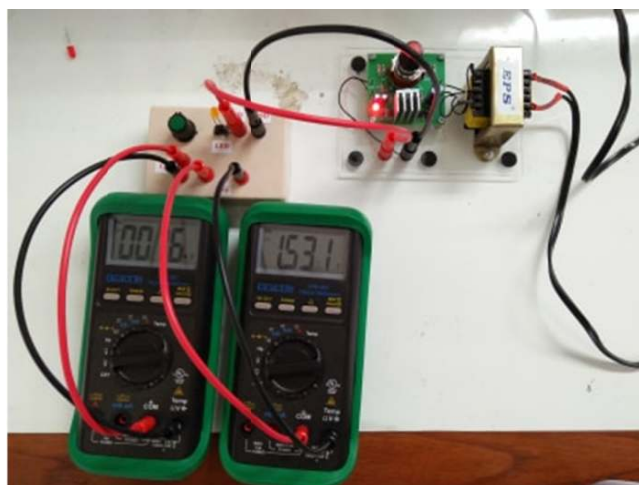
ภาพ 3 การต่อวงจรเพื่ออ่านค่า V_R และ V_D
