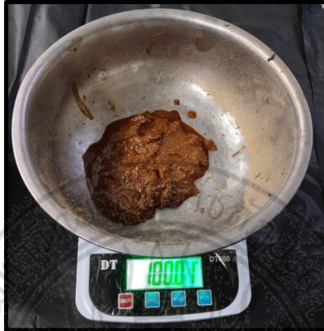
ภาพที่ 4.2 กากไขมันจากบ่อดักไขมันอุตสาหกรรมปลากระป๋องที่นำมาเป็นวัตถุดิบผสมเชื้อเพลิงชีว
