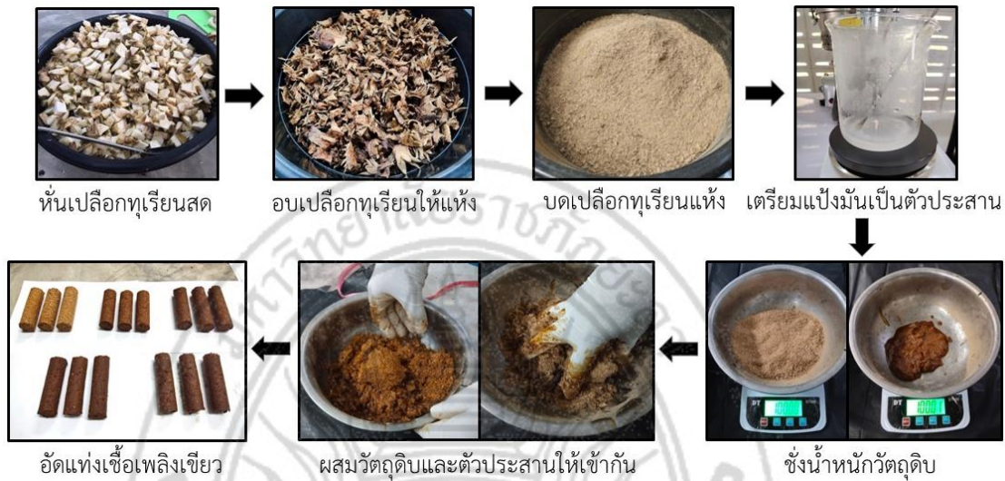
ภาพผนวก ข-1 ขั้นตอนการผลิตเชื้อเพลิงชีวจากเปลือกทุเรียนร่วมกับกากไขมัน
