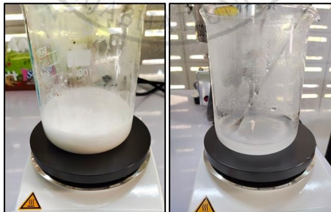
ภาพที่ 4.3 การเตรียมขี้เถ้าสำหรับเป็นขี้เถ้าเปียกเพื่อใช้เป็นตัวประสานเชื้อเพลิงชีว
