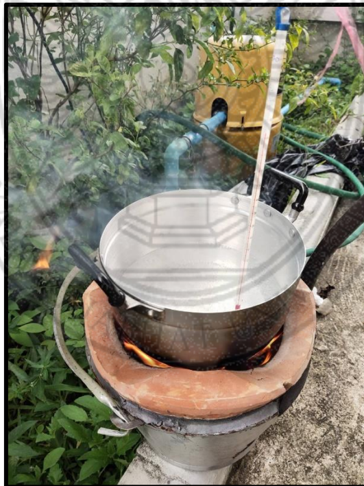
ภาพที่ 4.11 การทดสอบการต้มน้ำเพื่อหาประสิทธิภาพการใช้งานความร้อนของแท่งเชื้อเพลิงเขียว
