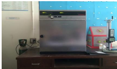
ภาพที่ 4 การนำผงถ่านที่ชั่งแล้วใส่ในตู้อบไล่ความชื้น
