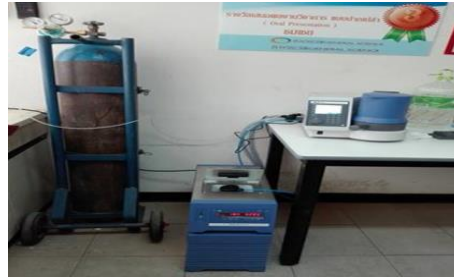
ภาพที่ 6 วัดค่าความร้อนจากเครื่อง Oxygen Bomb Calorimeter
