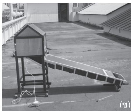
ภาพที่ 1 (ก) การเตรียมตัวอย่างทดลอง และ (ข) เครื่องอบแห้ง YRU-SID#1 (ST&E)
