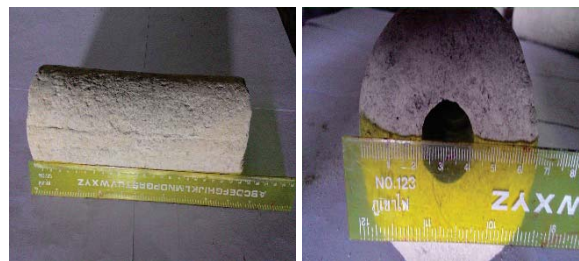
ภาพที่ 3 ขนาดความยาวและเส้นผ่านศูนย์กลางของไส้กรองน้ำเซรามิค
