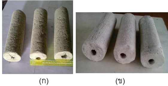
ภาพที่ 4 ไส้กรองน้ำเซรามิก ทั้ง 2 ชนิดซึ่งมีขนาดเท่ากัน (ก) ไส้กรองน้ำเซรามิกจากซีเถ้ากาบมะพร้าว และ (ข) ไส้กรองน้ำเซรามิกจากซีเถ้าไม้ยางพารา
