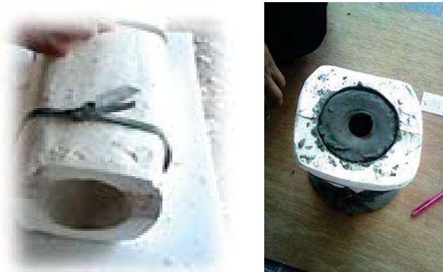
ภาพที่ 2 แม่พิมพ์และการหล่อไส้กรองน้ำเซรามิค
