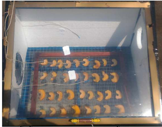
ภาพ 3 การลดความชื้นขึ้นส้มแชกด้วยเครื่องลดความชื้นพลังงานแสงอาทิตย์อย่างง่าย
