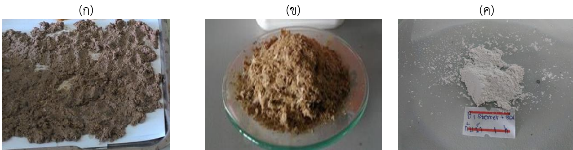
ภาพที่ 1 แสดงตัวอย่างกากบุดู (ก) กากบุดูที่ผ่านการล้าง (ข) และผงไฮดรอกซีอะพาไทต์ที่สังเคราะห์ได้ (ค)
