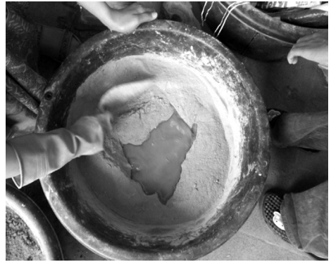
ผสมส่วนผสมของ ดินลูกรัง : แก้วไม้อย่างพารา : ทราย : ปูนซีเมนต์ปอร์ตแลนด์
