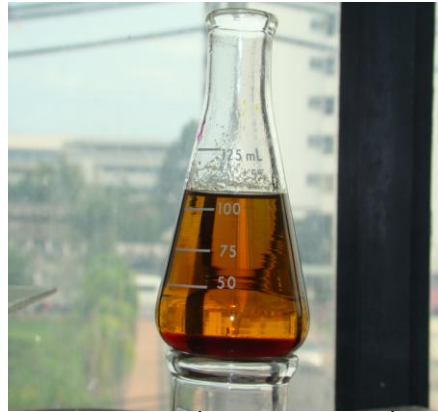
รูปที่ 2ข การแยกชั้นของไบโอดีเซลชั้นบนและกลีเซอริน
