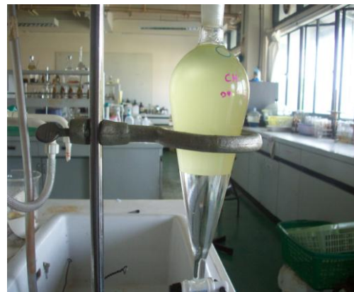
รูปที่ 3 การล้างซ้ำๆ การผ่านน้ำหลายๆชั้น โดยใช้หลักการลอยตัวของน้ำมัน (ขวา) ใช้กรวยแยก
