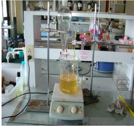
รูปที่ 2ก การเตรียมไบโอดีเซลจากปฏิกิริยาทรานส์เอสเทอร์ิฟิเคชัน
