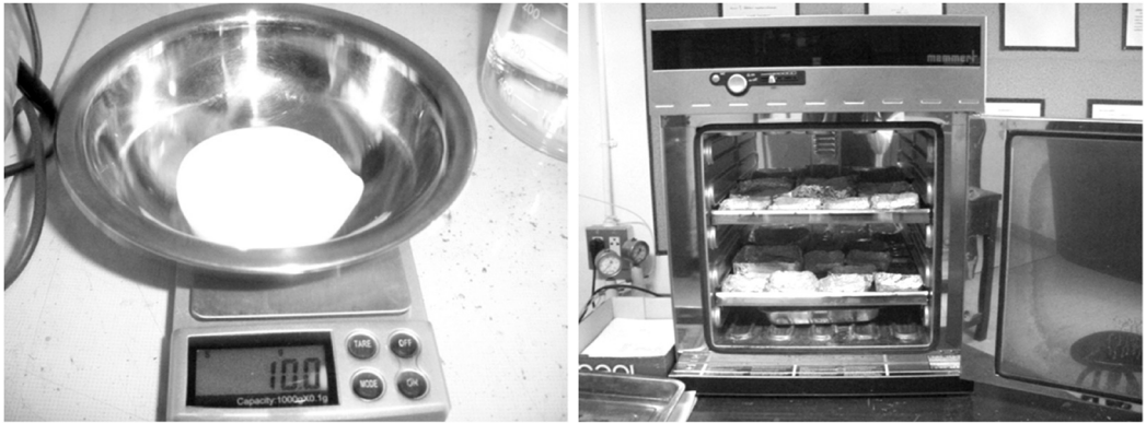
ภาพที่ 5 การหาลอยละเนื้อเยื่อแห้งตามวิธีมาตรฐาน ISO 126:1995 (ปรีดาวรรณ ไชยศรีชลธาร และคณะ, 2554)
