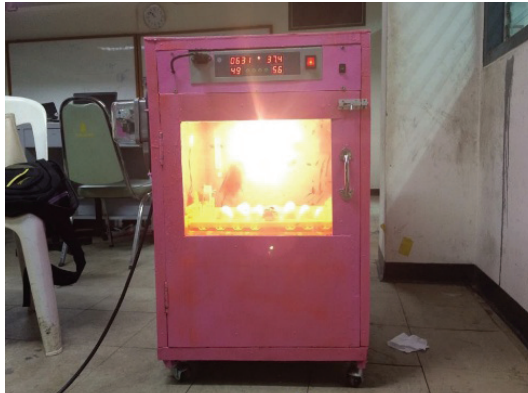
ภาพที่ 3 ตู้ควบคุมอุณหภูมิในการฟักไข่โดยการกลับไข่อัตโนมัติ
